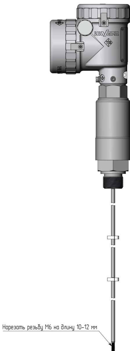
Рисунок М1.4 – Нарезание резьбы М6
