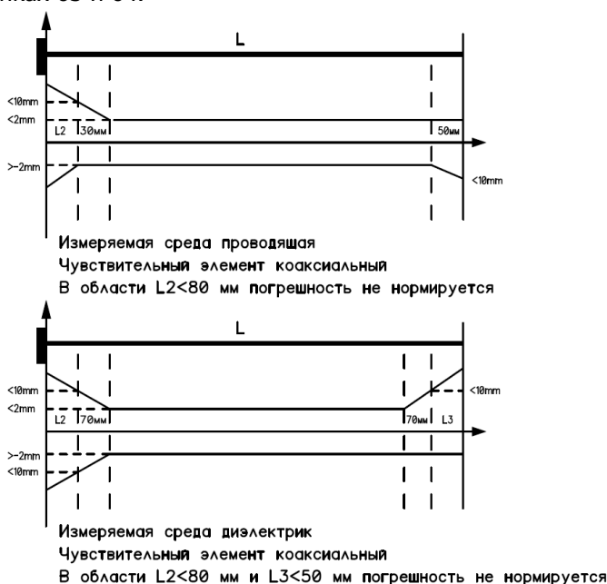
Рисунок 63. Пределы допускаемой абсолютной погрешности преобразователя с коаксиальным чувствительным элементом
