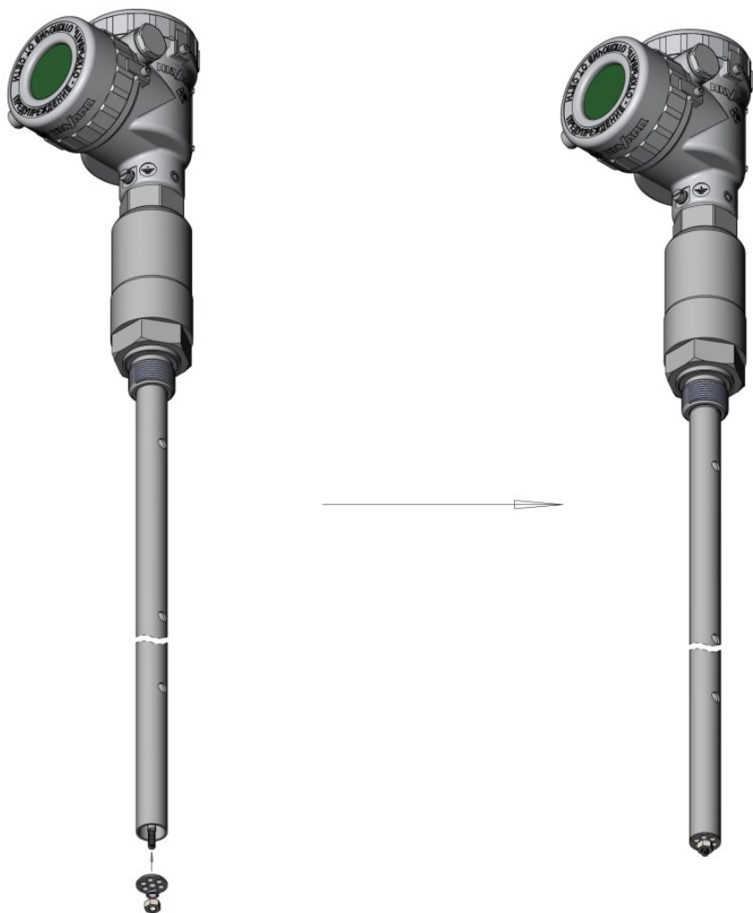
Рисунок М1.6 – Установка заглушки коаксиального зонда
