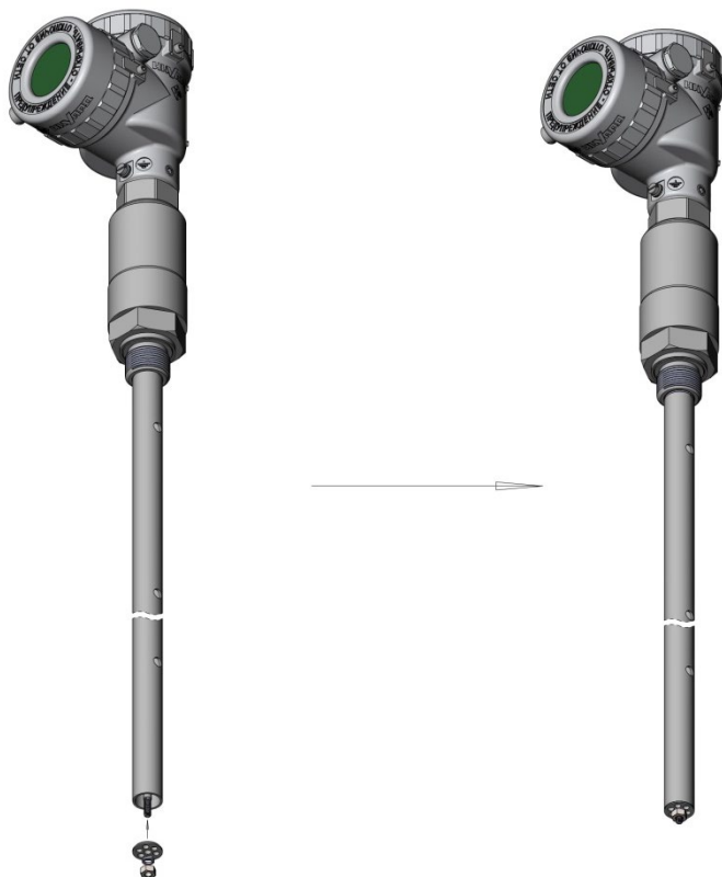
Рисунок Е20 – Установка заглушки коаксиального зонда
